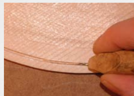
Abb. 40 Ausheben mit dem Spanausheber
