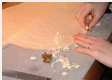
Abb. 35 Herstellen der Randstärke
