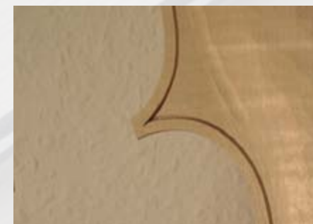
Abb. 41 Fertiggestellte Nut an Bodenecke
