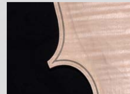
Abb. 44 Fertige Späneinlage an Bodenecke
