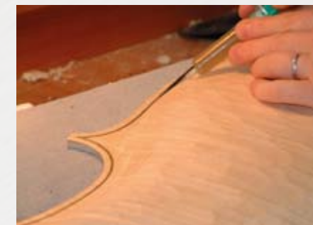
Abb. 43 Einleimen des Spanes in die Nut
