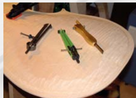
Abb. 37 Werkzeuge zum Anzeichnen der Nut
