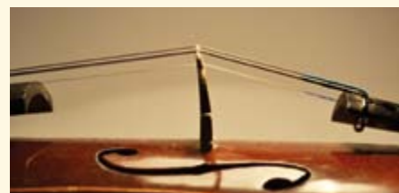
Abb. 4 Violine mit stark verkrümmtem Steg
