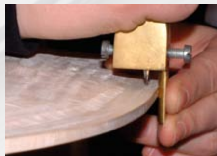
Abb. 38 Verwendung des Schneidzeugs
