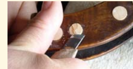
Abb. 2 Zurückschneiden des Ausbuchers
