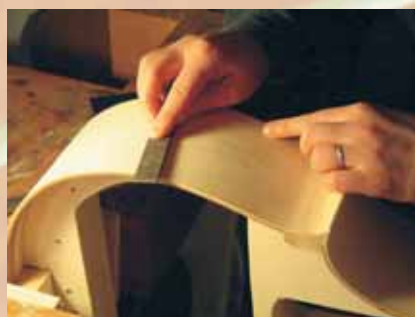
Abb. 28: Übertragung des Umrisses auf die Decke
