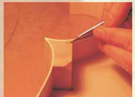
Abb. 22: Kontrolle der Reifchenmaße Abb. 23: Einschneiden des Kästchens in einen Eckklotz
