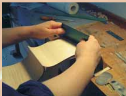
Abb. 26: Putzen des Zargenkranzes mit der Feile Abb. 27: Putzen des Zargenkranzes mit der Zieh Klinge
