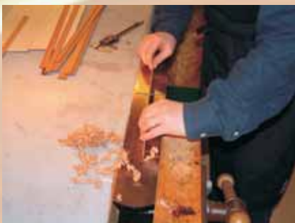
Abb. 21: Hobeln der Reifchenhöhe
