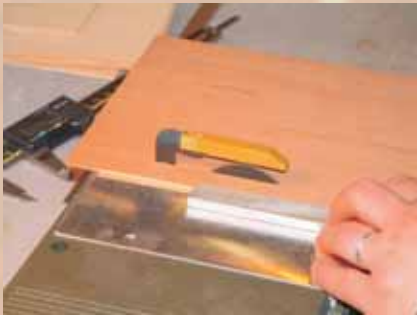
Abb. 20: Sägen der Reifchenleisten
