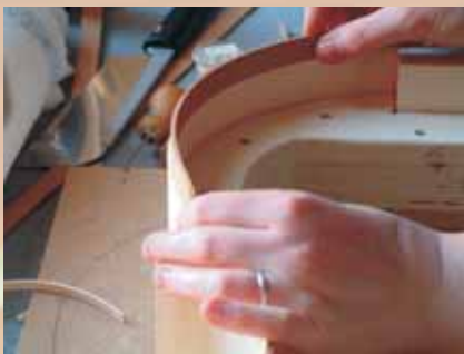
Abb. 24: Biegen einer Reifchenleiste Abb. 25: Kontrolle des Biegeverlaufs
