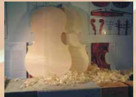
Abb. 28: Übertragung des Umrisses auf die Decke
