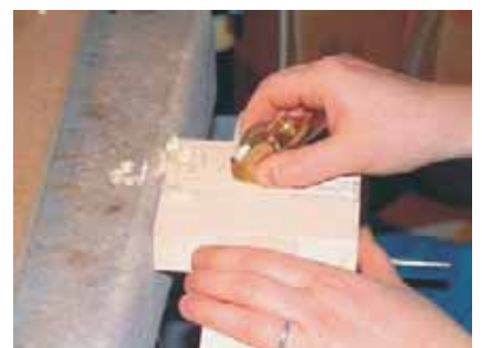
Abbildung 10: Formgebung mit dem Wölbungshobel
