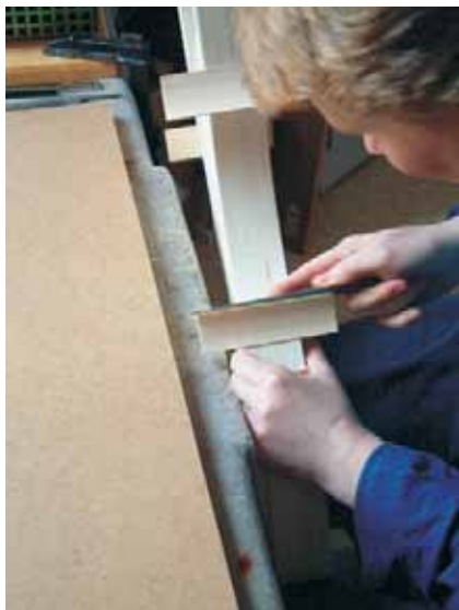
Abbildung 12 (oben): Kontrolle mit dem Haarwinkel Abbildung 13 (unten): Endbearbeitung des Eckklotzes
