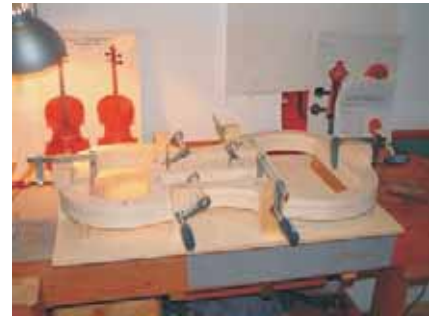
Abbildung 9: Anleimen der Stöcke und Klötze an die Innenform
