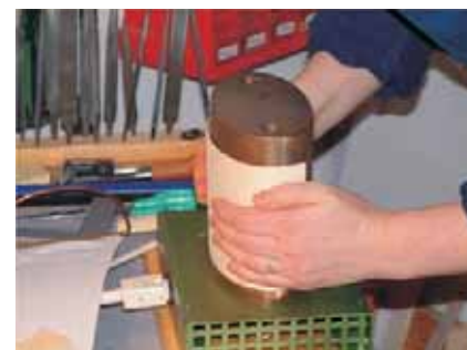
Abbildung 16: Geigenmachermeisterin Claudia Rook beim Biegen einer Mittelbugzarge
